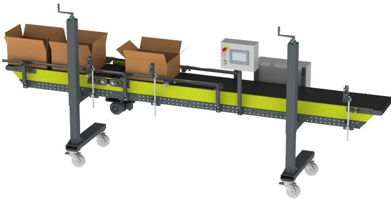
La llenadora automática de cajones y cajas es el complemento perfecto para sus líneas de llenado de cajones de madera / cajas de cartón. Un diseño confiable, fácil de integrar con la maquinaria existente y compatible con el sistema de alimentación de cajones/ cajones manual o automático.
